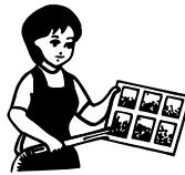
**3** Rengjør luftrengjøringsfilteret annenhver uke om apparatet benyttes i et ekstremt støvete miljø.
